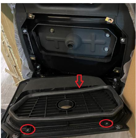
2. Ta ut den eksisterende pakningen, og skru ut ventilatordeksel. Dette dekselet skal ikke gjenbrukes.
