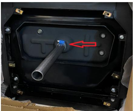
3. Sett på røret og den medfølgende slangeklemmen, skru til slangeklemmen
